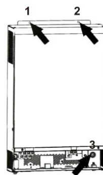
Рис. 7. Схема монтажных зазоров и крепления (винты М6×80 мм и М4/М5)
